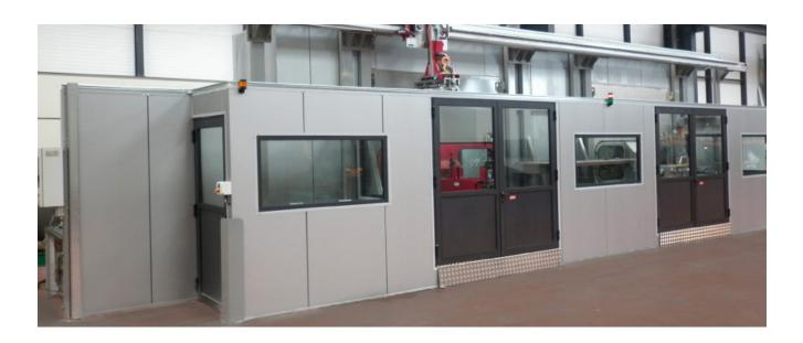
SiiF hat Roboterzelle für die Endbearbeitung von Teilen aus Grauguss oder GS entwickelt.
