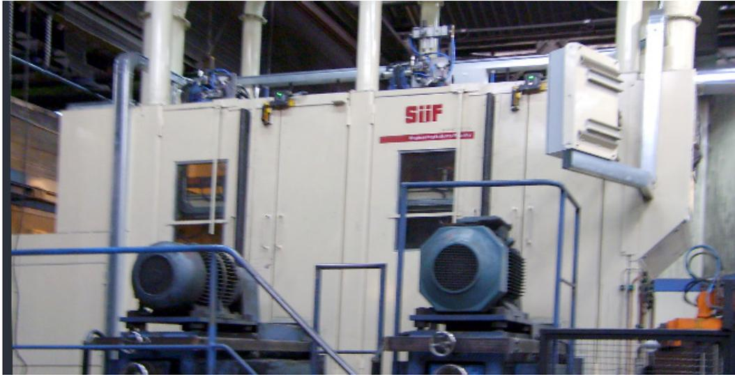
Für die Endbearbeitung von Motorblöcken aus Gusseisen und Zylinderköpfen aus Gusseisen bietet Siif 4-Flächen-Schleifmaschinen an
