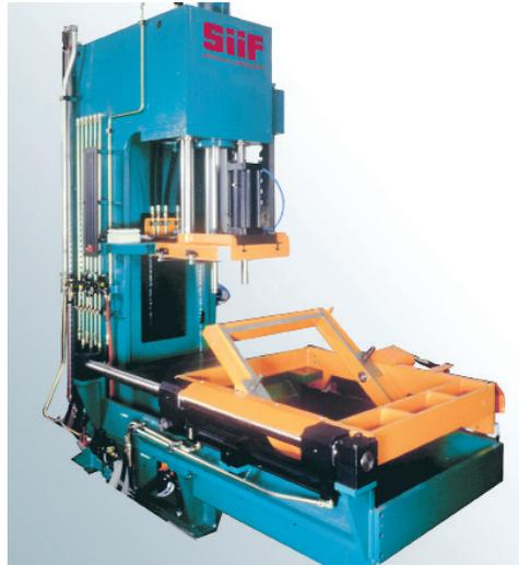
Siif bietet eine komplette Reihe von Shuttle Entgratmaschinen für das Entgraten der Teilungsgrate an.
