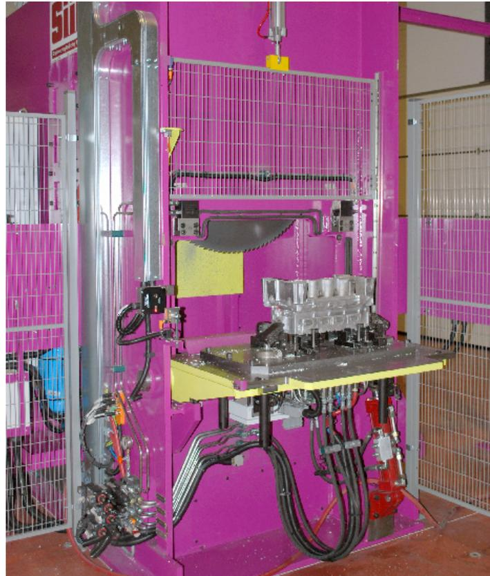
SiiF bietet die Säge für den Schnitt von Speisern für Aluminiumussteile an.
