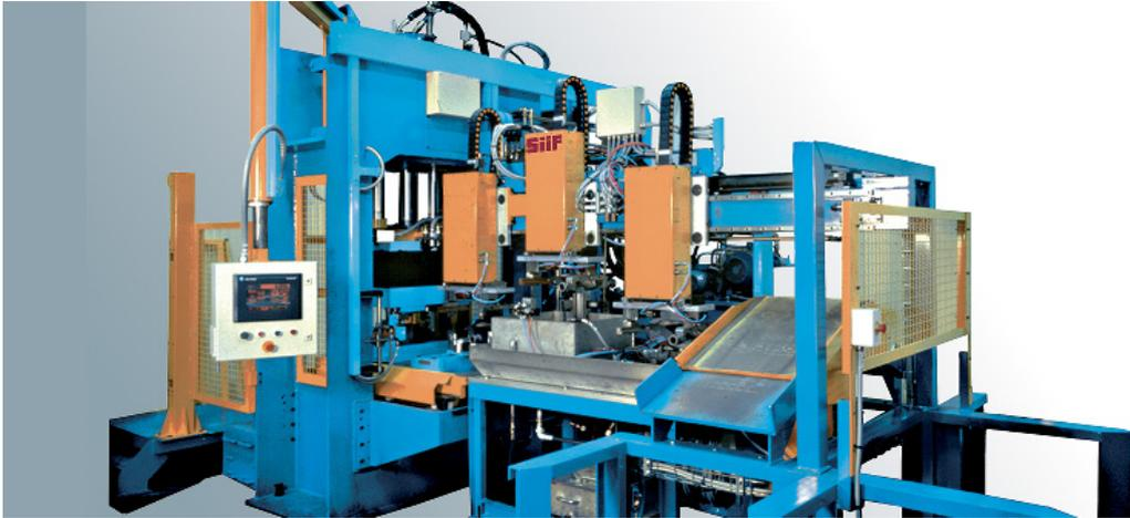
Durch die Integration der besten Geräte zur zerstörungsfreien Prüfung und Messung führt Siif nach der Endbearbeitung die von den Herstellern vorgegebenen Kontrollvorgänge durch.
