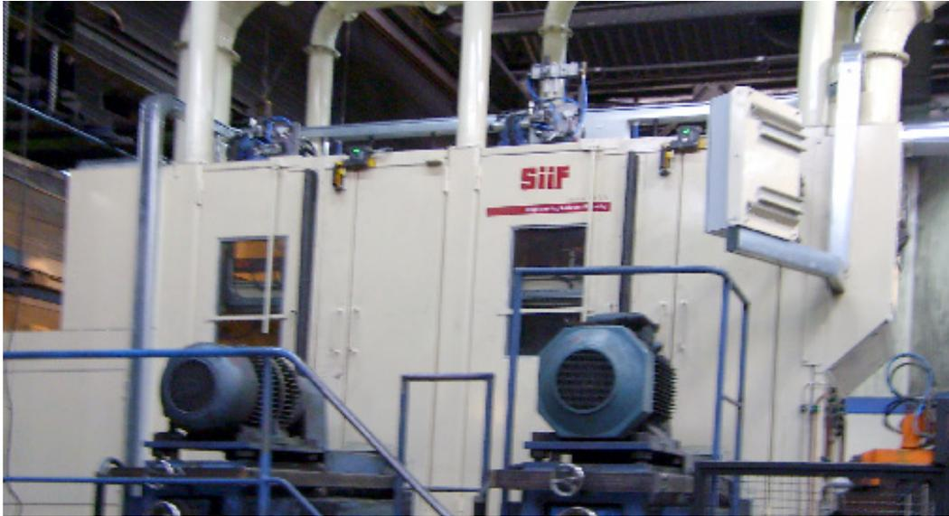
Siif Vorfräsmaschinen werden hauptsächlich für Zylinderköpfe eingesetzt und stellen die Abmessungen der Gussteile vor der Bearbeitung sicher.
