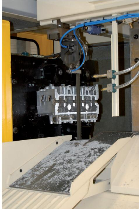
Seit mehr als 20 Jahren entwickelt und fertigt SiiF Bandsägen für das Schneiden von Aluminiumsteigern und Eingüssen.
