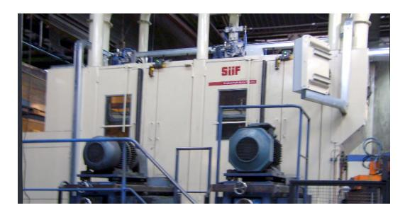
Para el acabado de bloques de motores de hierro y culatas, SiiF ofrece rectificadoras de 4 caras.
