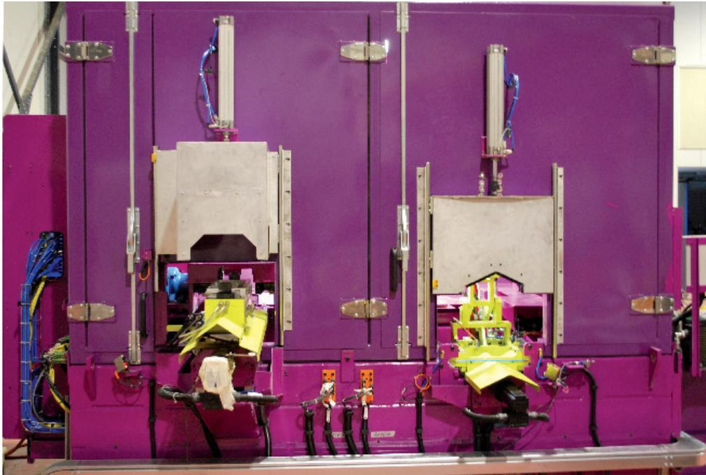
Principalmente aplicadas a las culatas, las máquinas de "cubing" SiiF garantizan las dimensiones de las piezas antes del mecanizado
