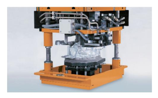
Siif provee herramientas de recorte para piezas en aluminio producidas en fundición a alta presión, a baja presión o por gravedad
