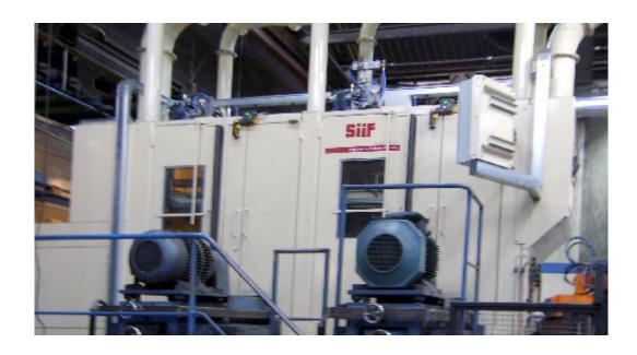
Para el acabado de bloques de motores de hierro y culatas, SiiF ofrece rectificadoras de 4 caras
