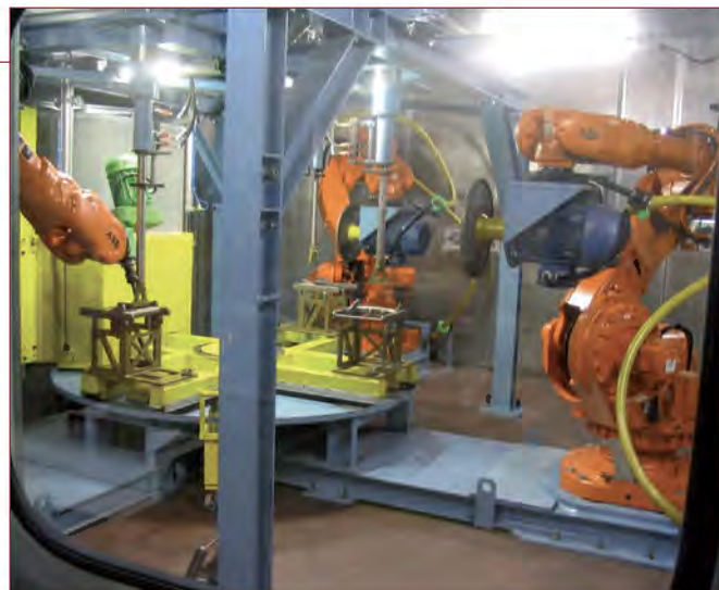
→ 铁铸件机器人清理单元 【效率，每小时可完成145个减速器壳体，每小时可完成280个差速器壳体】
