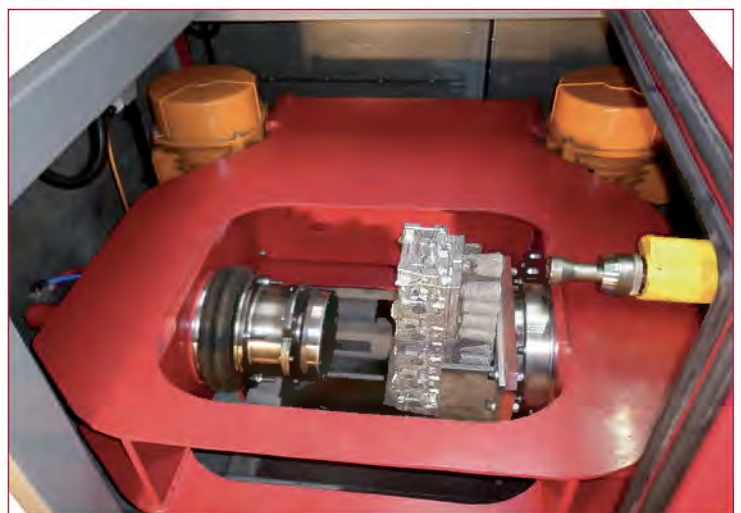
→ R型振芯机的机架
