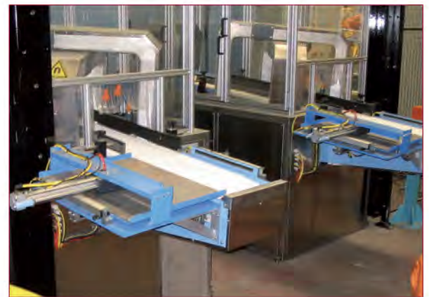
→ 并联式【两台机器同时检测】铸件磁化线【800件/小时】
