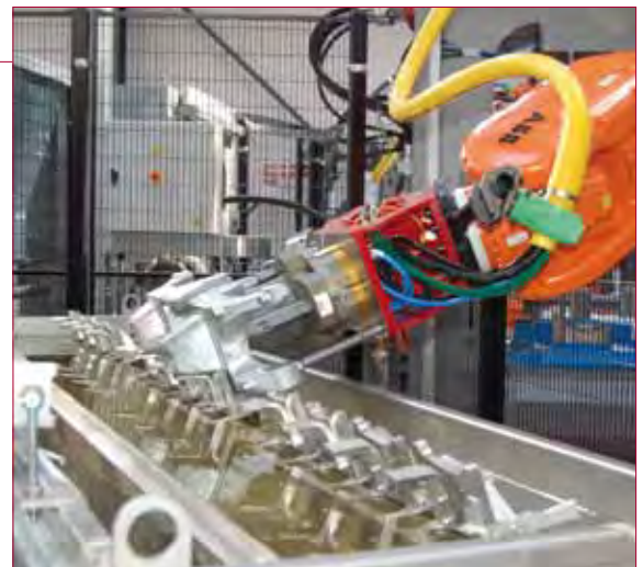
→ Bac de refroidissement eau
