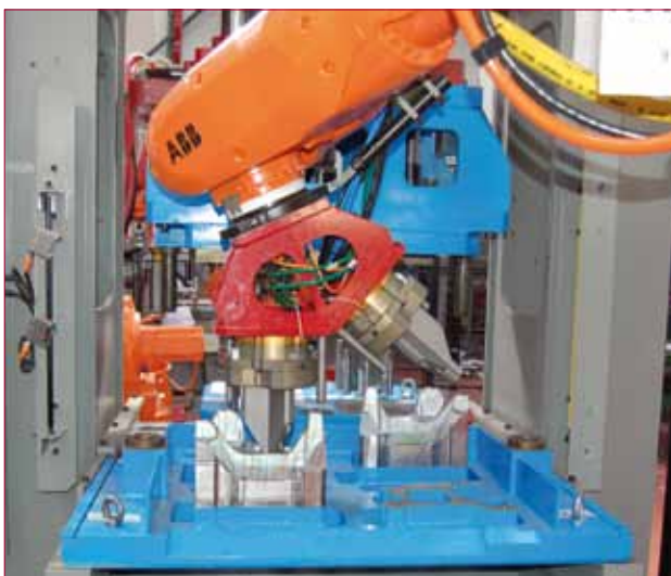
→ Chargement robotisé de la détoureuse «Arcade»
