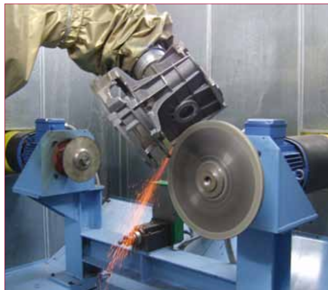
→ Cellule de meulage
