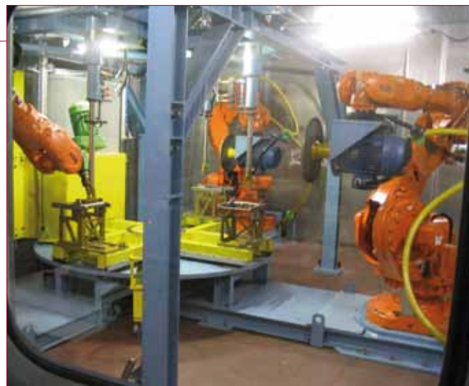
→ Cellule robotisée fonte (temps de cycle, boîtier réducteur = 145 pièces / heure, boîtier différentiel = 280 pièces / heure)
