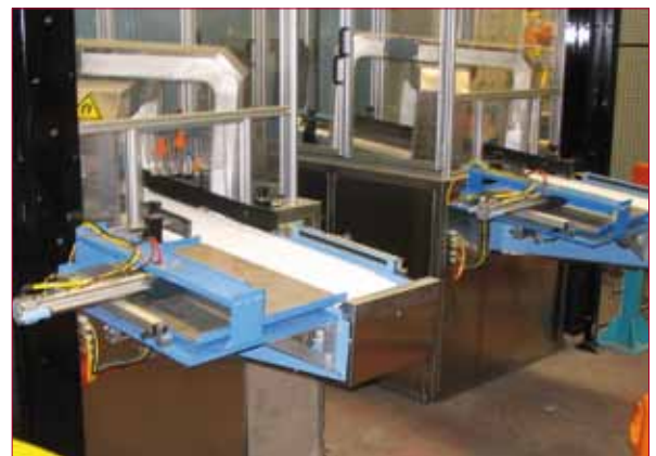
→ Lignes de magnétisation en tandem (800 pièces/heure)
