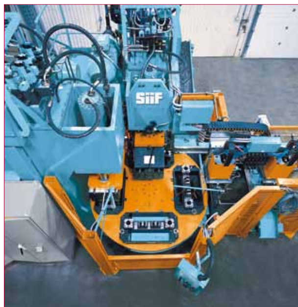
→ Détoureuse, 4 stations avec outils pour étriers de frein
