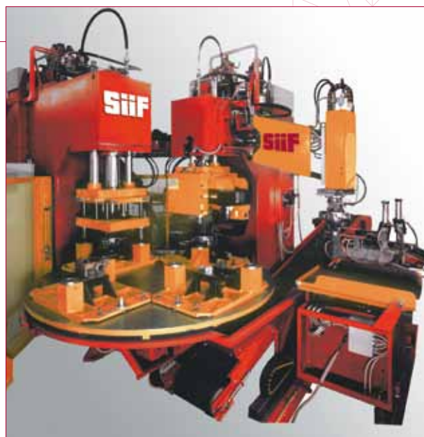
→ Détoureuse, 4 stations avec outils pour boîtier différentiel
