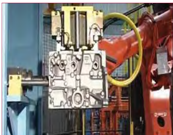
→ Finition d'une pompe à eau
