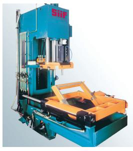
SiiF propose une gamme complète de machines de finition à chariot pour le détourage du plan de joint.
