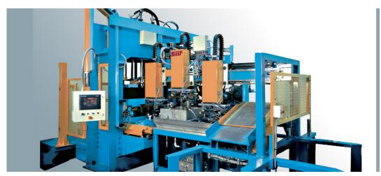
Al integrar el mejor equipo de medición y ensayos no destructivos, SiiF realiza las operaciones de inspección especificadas por el fabricante a continuación del proceso de acabado.
